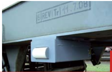
Osazení sledovací jednotky systému SIMON na železniční nákladní vůz
