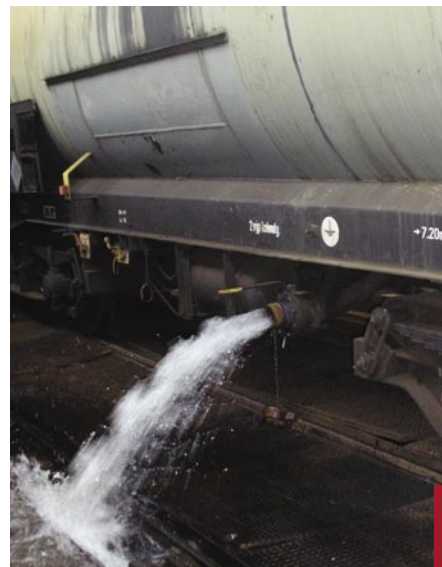
Vypouštění železniční cisterny ve VADS Bohumín.
